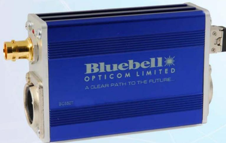
BC550Tは、光ファイバケーブルを介して3G-SDI、HD-SDI、SD-SDI、またはASI信号を送送するためのトランスミッタモジュールです。入力信号は自動検出され、イコライジングおよびリクロック回路を経てファイバケーブルでの伝送のための光信号に変換されます。オーディオまたはコントロールデータ用の逆方向パスが第2のファイバI/Oとして搭載され、リモートカメラシステムやトークバックなどの用途に最適な費用対効果高いソリューションです。
