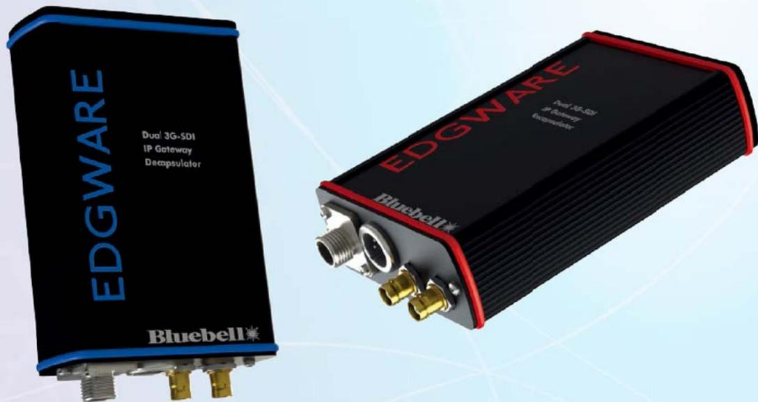
Edgware IP エンカプスレータ モジュールは、ブロードキャストワールドと IP ネットワーク間を橋渡すシンプルで非常に強力なエッジデバイスです。
