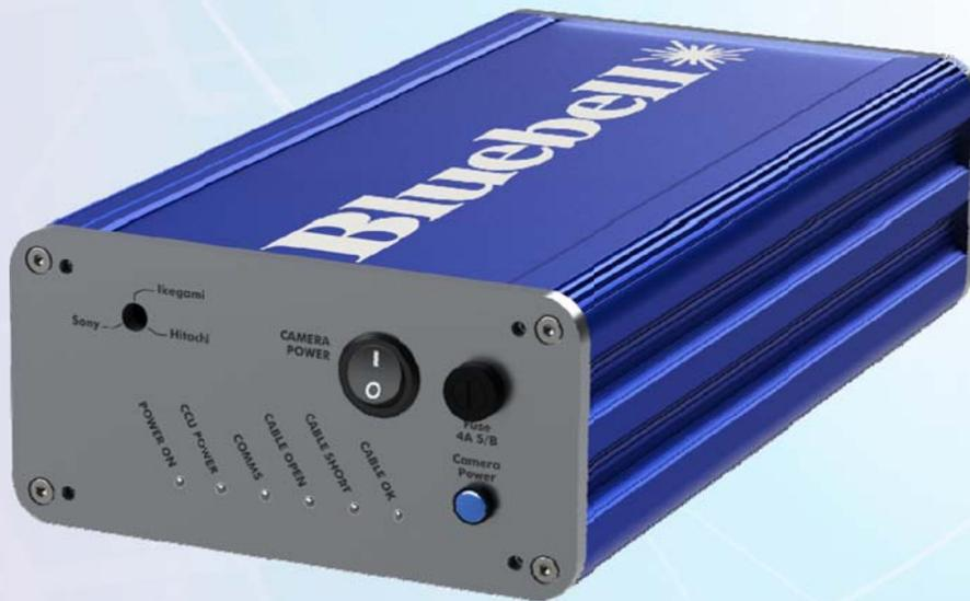
ブルーベルのShaxXシステムは、標準のSMPTEハイブリッドコネクタが装備されたカメラへハイブリッドケーブルを介し電源の供給とファイバー伝送を提供するよう設計されています。電源は、ハイブリッドケーブルを介し最大300mの距離までのリモートカメラに供給が可能です。Shax-CCUと組み合わせると、カメラは通常のシングルモード光ファイバーネットワークを使用して、遠隔のスタジアムやキャンパスなどに展開して使用可能となります。
